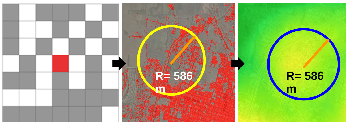
Imagen 3. Ejemplo de análisis de entorno. A la izquierda la clasificación obtenida de píxeles construidos/no-construidos; al centro la definición del entorno y a la derecha el valor promedio del entorno, para cada píxel.
